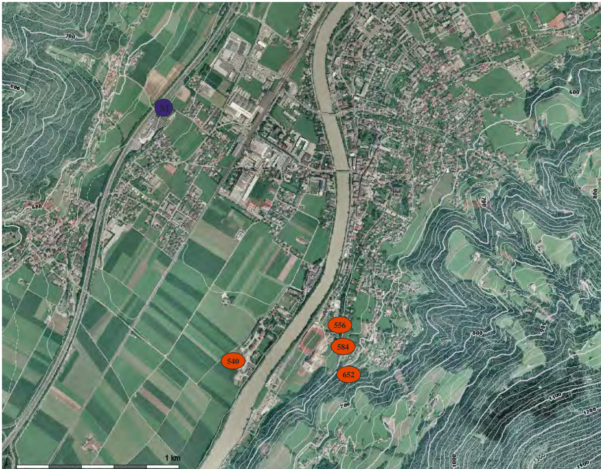
Abbildung 1: Lage der verwendeten meteorologischen Messungen im Raum Schwaz. Die roten Punkte markieren mit Höhenangabe die Messpunkte des Temperaturprofils. Der blaue Punkt kennzeichnet die Lage der Wind- und Globalstrahlungsmessung.
