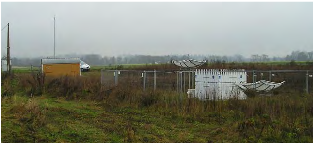
Abbildung 1: Aufstellung der Messgeräte. USA (hinter dem orangefarbenen Container). Rechts im Bild ... RASS (METEK).
