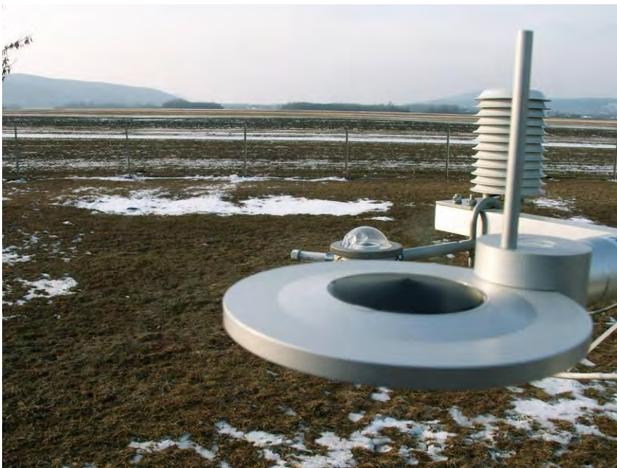
Abbildung 3: Strahlungsbilanzgeber von Kipp&Zonen (Vordergrund) und Schenk (Hintergrund, mit Kunststoffglocke). Beide Geber sind ungefähr gleich groß, die Verzerrung ist durch die Optik des Photos bedingt). Dahinter: Wetterhütte.
