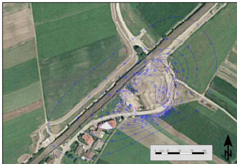
Bild 6b: Baumkirchen 2005: mit AUSTAL2000 prognostizierte durchschnittliche PM10 Zusatzimmission
