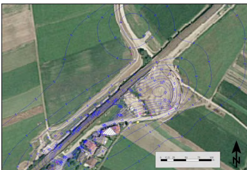
Bild 7b: Baumkirchen 2006: mit AUSTAL2000 prognostizierte durchschnittliche PM10 Zusatzimmission
