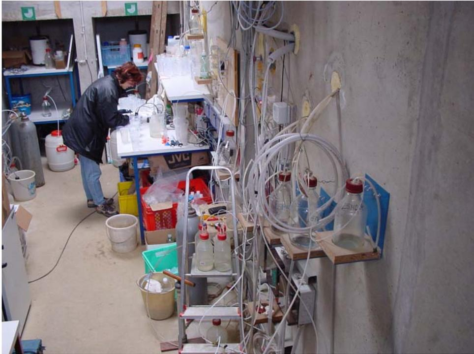
*Foto 5: Entnahme der Proben für die Sickerwasseruntersuchung auf Glyphosate in der Lysimeteranlage*
